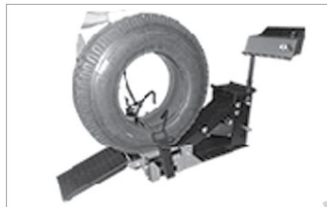
3. В соответствии с размером шины, ремонт которой необходимо произвести, установите механизм фиксации на необходимую высоту. Установите длинный захват так, чтобы он был соединен с рычагом подъемного устройства. Отрегулируйте положение захвата, передвигая рычаг с захватом вверх и вниз для того, чтобы совместить его с одним из семи (7) регулировочных отверстий. Поверните короткий захват внутрь шины и постараитесь поместить шину посередине между прижимными рычагами.
